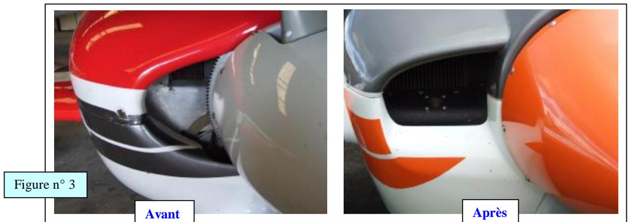
4-2 ) Utiliser un cône d'hélice de diamètre > 300mm.
