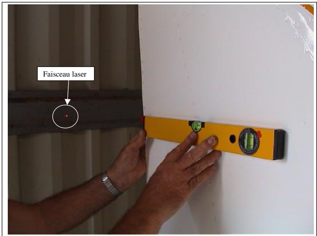
Mesure du débattement de la gouverne de direction à l'aide du niveau laser
