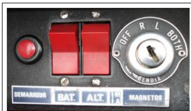
Remarque : 1 ) On se souviendra que le test de la magnéto droite est à gauche et celui de la magnéto gauche est à droite.
