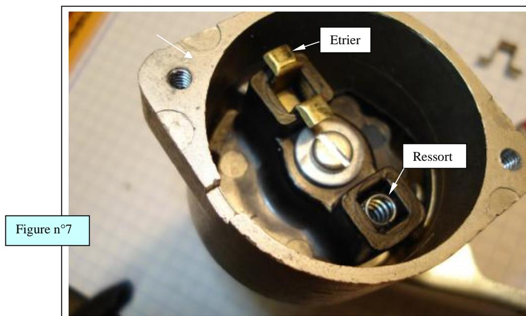
**La platine arrière** sur laquelle sont moulés les contacts, qui ressortent à l'arrière par des vis et écrous.
