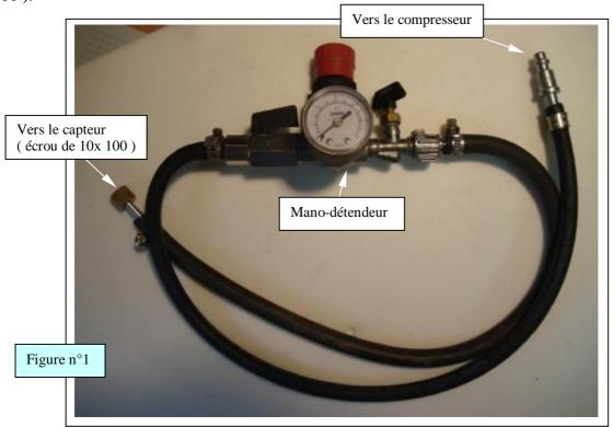
3) <u>Essai</u>: Après avoir raccordé les tuyaux, (voir figure n° 2) un aide monte dans l'avion pour noter les valeurs lues sur l'indicateur. La mise en pression se fait progressivement par le bouton moleté rouge. On étalonnera les valeurs 2, 4,6, 8 et 10 bars. Par commodité, on affichera ces valeurs sur l'indicateur de pression d'huile, et on lira les valeurs correspondantes sur le manomètre du détendeur.
