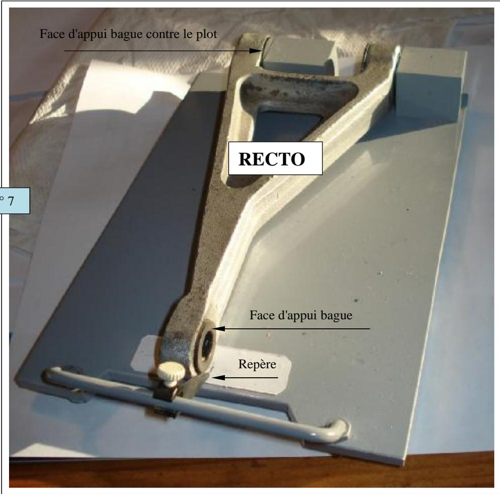
**Remarque** : Il est important de bien serrer la face d'appui de la bague gauche de diamètre 14 mm contre le plot, pour positionner exactement la fourchette latéralement, et cela, à chacune des 2 positions (recto et verso) de la fourchette
