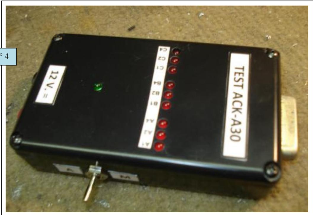
Le testeur est contenu dans un boîtier plastique de 85 x 50 x 22 mm mini extérieur. Il comprend les 9 diodes et une autre diode LED verte, pour indiquer la mise en marche. Toutes les diodes sont de diamètre 3 mm.
