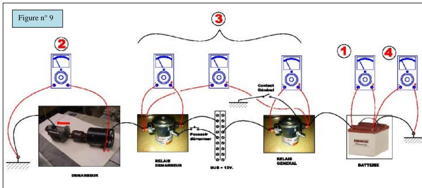
Le test se fera directement sur l'avion à l'aide d'un voltmètre si possible analogique ( à aiguille ) et en 4 étapes : **Assurer la sécurité autour de l'hélice .**
