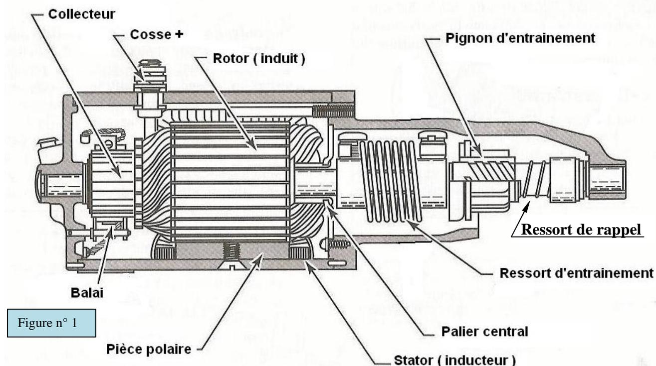
2-1) : **Le Moteur** : Le principe est celui du moteur « Série » : le courant d'alimentation passe de la cosse + vers le stator, puis dans le rotor, au moyen d'un collecteur et des balais (charbons), pour finir à la masse du démarreur. Ce type de moteur possède un fort couple de démarrage, ce qui nous convient bien pour lancer le moteur de l'avion.
