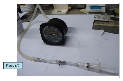
totale sur le tube de pitot, et l'on se place dans la cabine, avec la seringue ( d'où la longueur de tuyau) pour surveiller le cadran du badin, et l'on applique une surpression telle que l'aiguille dévie au maximum au ¾ de la pleine échelle des vitesses ( attention à bien surveiller le cadran avant d'appliquer la pression au risque d'endommager l'instrument!).
