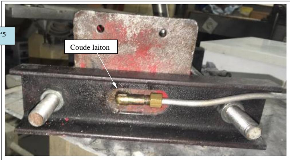
Pour bloquer l'élévation du piston lors du pompage, nous utilisons 2 profilés en U de 60x40 mm et de longueur 225 mm , raccordés par 2 tiges filetées de diamètre 14 mm et de longueur 380 mm ( dépendant de la hauteur du cric) voir figure n°6.
