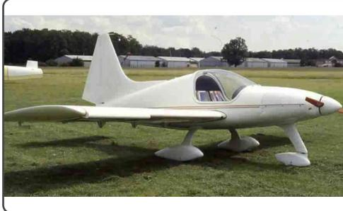
Appareil biplace côte à côte à Train Tricycle Fixe, à ailes médianes basses et empennage monodérive classique Technologie Composite Carbone intégral (Cat. ULM-F : + 4,0 -2,0)
