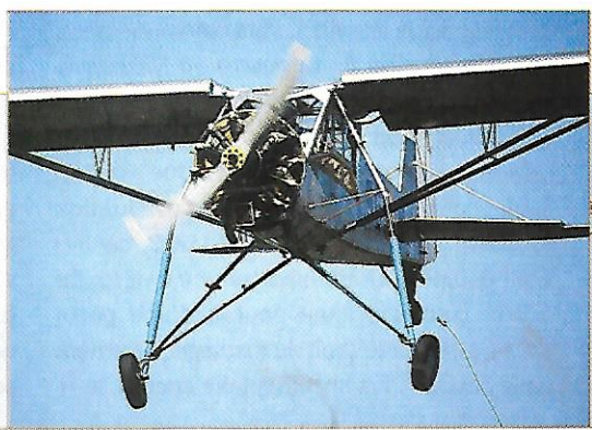
A gauche, un rare Storch remotorisé par un Lycoming de 235 ch. Pour les Morane-Saulnier MS-500/505 Criquet (construits sous licence après guerre), utilisés pour le remorquage de planeurs, la motorisation retenue fut le Jacobs en étoile de 300 ch
