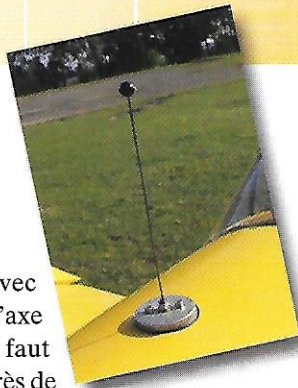
La fameuse jauge à flotteur "à la Delemontez", simple et fiable...
