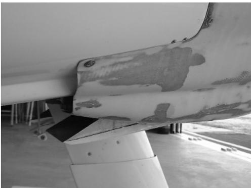
Les côtés du capot englobent la sortie d'air de refroidissement cylindres, ainsi que l'échappement du côté gauche.
