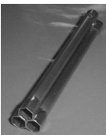
Simple à fabriquer ce type de faisceau offre à l'air de refroidissement la même surface d'échange qu'au liquide.
