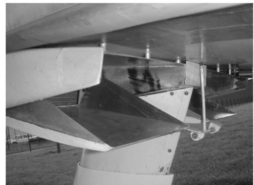
La commande de volet de capot est très simple et directe. Nous avons conservé la graduation en mm d'ouverture utilisée pendant les essais en vol : 0 mm, 4 mm (3,6 % de la section du radiateur), 8 mm (7,3 %), 14 mm (13 %), 22 mm (20 %), 35 mm (32 %), etc.
