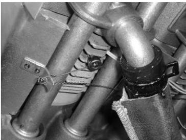
Entre les ailettes du cylindre 2, une prise de température conforme aux indications de Rotax, et protégée des courants d'air par un morceau de mousse.
