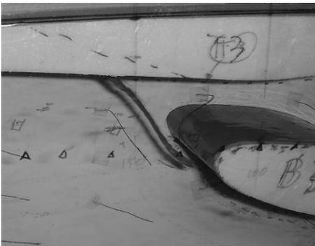
Avec une sortie fermée, il se forme un coin "d'eau morte" devant l'entrée, et l'écoulement contourne le tunnel sans turbulence ni décollement.
