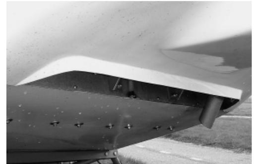
Remarque : on suggère parfois de placer la sortie dans une zone de dépression. Si l'on peut ainsi faciliter la sortie de l'air, rien n'est gratuit : on fait payer le travail d'extraction par l'écoulement général, avec une traînée accrue (réf. 5 et 7).
