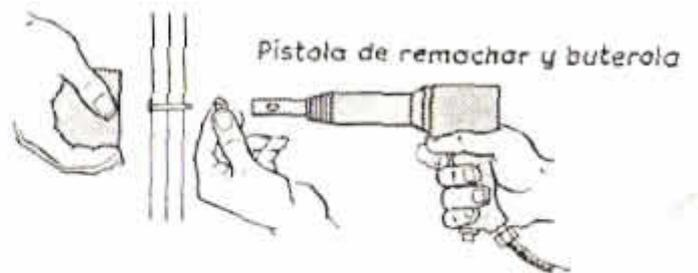
Fig. 29 Preparación para instalar un remache Hi-Shear con una pistola de remachar y una buterola
