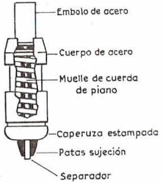
Fig. 23. Elementos del sujetador Wedglock
