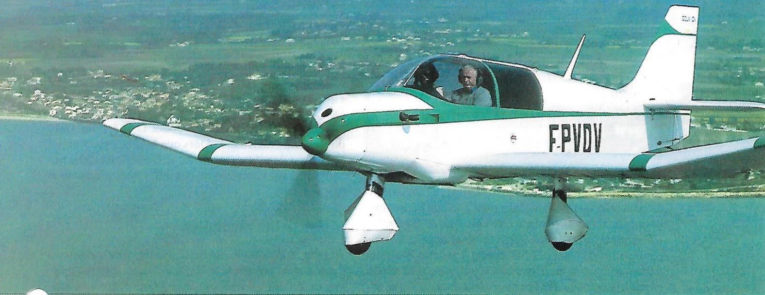
diamètre (même fabricant) était en place sur le nez de l'appareil. Moins performante en vitesse de croisière (220 contre 230 km/h), cette dernière est destinée à la version remorqueur de planeur qui doit voler prochainement. Actuellement et compte tenu des paramètres, l'hélice Arplast semble très bien convenir au diesel. La légère souplesse de l'ensemble permet d'absorber les variations de couple. Son pas réglable (au sol) et sa faible masse sont autant d'atouts.
