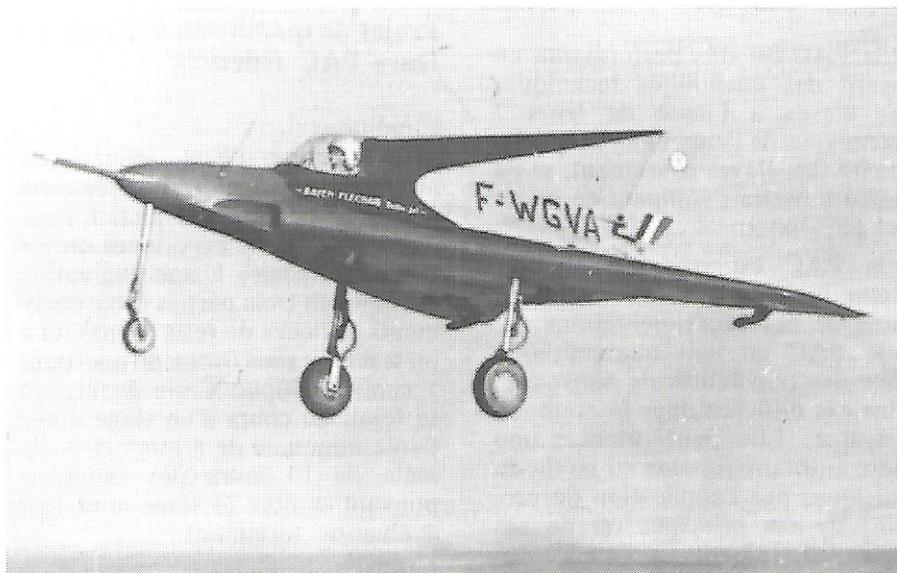
**Performances du PA 49 "Katy" : vitesse maximale avec train escamotable : 500 km/h - Vitesse de croisière : 370 km/h - Vitesse d'atterrissage avec volets fléchair : 105 km/h - Roulage au décollage : 420 m. Roulage à l'atterrissage, avec volets fléchair et freins : 250 m.**
